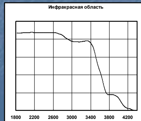
Спектры пропускания в ультрафиолетовой, видимой и инфракрасной области (без учета поправки на отражения) BS-2012-03
