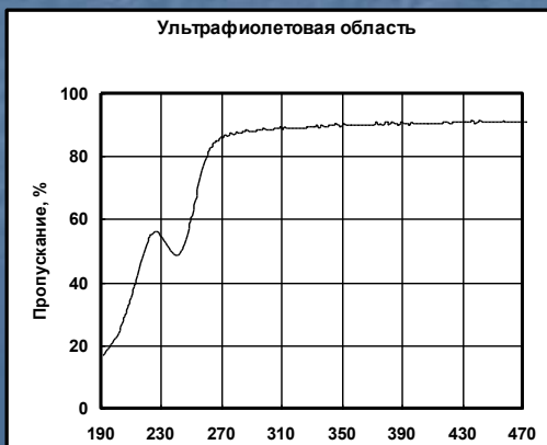
Спектры пропускания в ультрафиолетовой, видимой и инфракрасной области (без учета поправки на отражения) BS-2012-03
