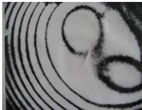
Коноскопические фигуры в «высокоградиентном» кристалле с остаточными термоупругими напряжениями и наведенной оптической двуосностью (овалы Кассини)
