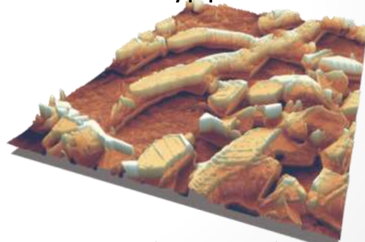
Кристаллы борнита на образце CuFeS 2 с плёнкой Fe+Cu, отожженного при 550°C с буфером CuFeS 2
