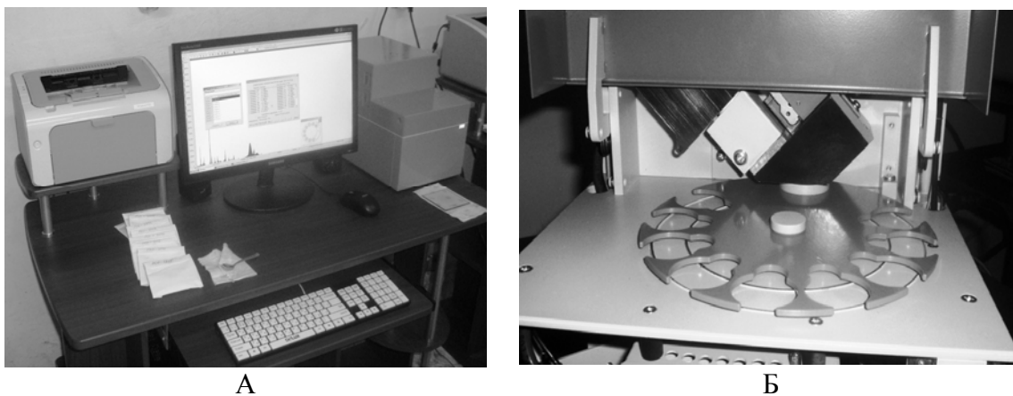
Рис. 1. Спектрометр РЛП-21Т 4-го поколения: общий вид (А), датчик (Б)
