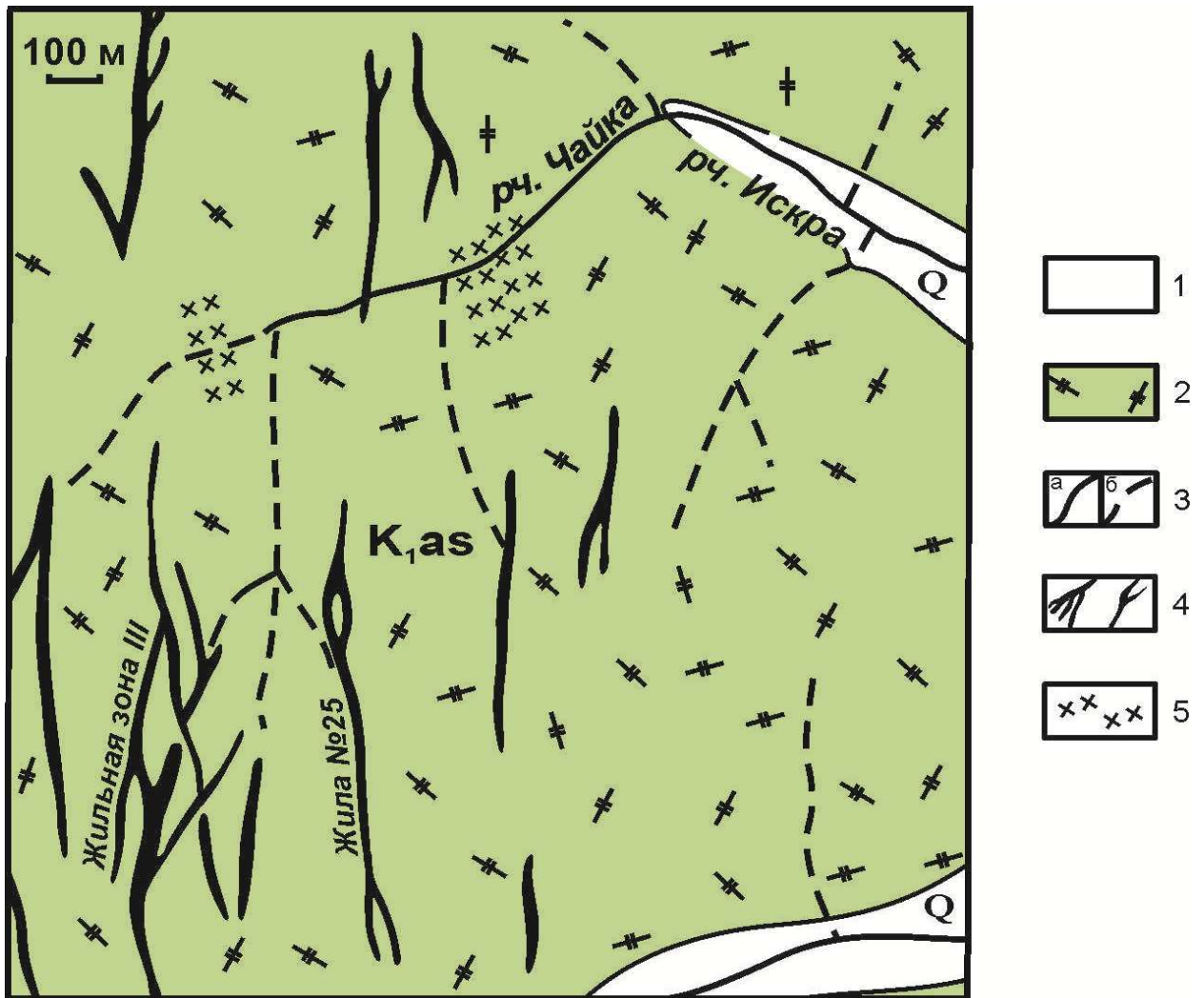
Рис. 46. Схема расположения водотоков I-II порядка, уч. Чайка, Дукатское месторождение: 1 – рыхлые четвертичные отложения (Q); 2 – мелкопорфировые риолиты, флюидальные риодациты, игнимбриты риолитов и риодацитов, аскольдинская свита ( K_{1as} ); 3 – водотоки I порядка: а – постоянные, б – временные; 4 – рудные тела; 5 – зоны с мелкими жилами и прожилками Ag-Pb состава.
